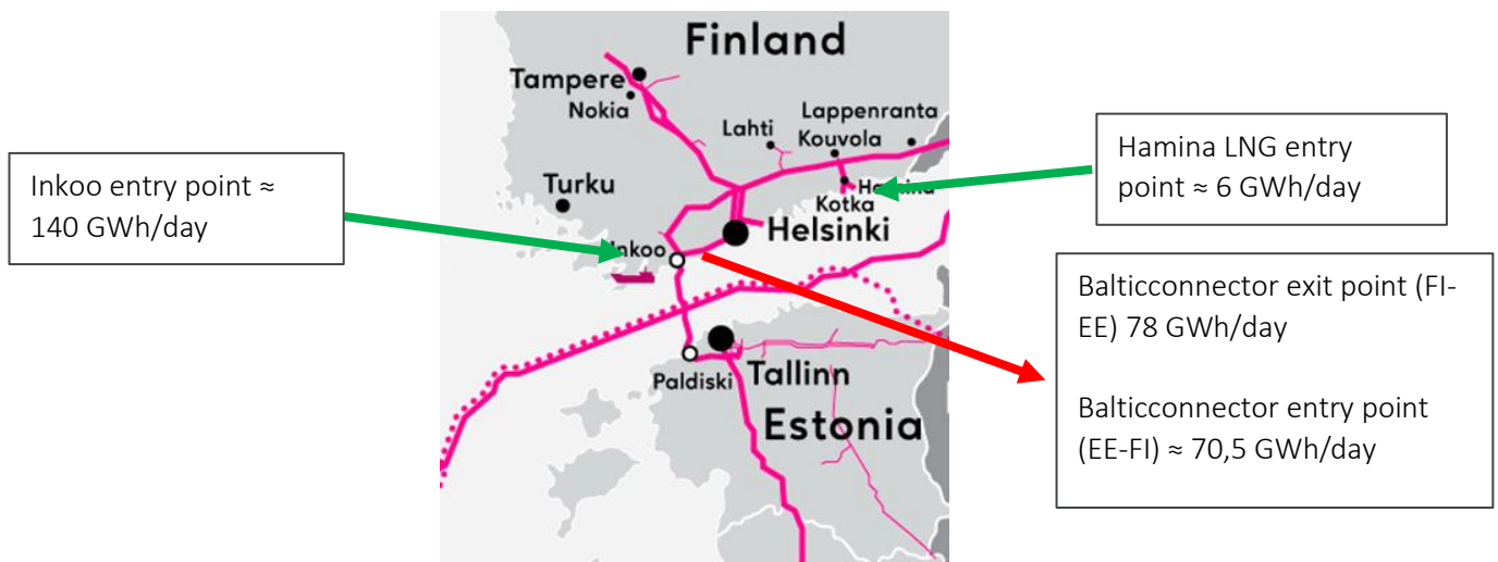
Kuva 3. Tekniset kapasiteetit syöttö kelluvan LNG-terminaalin kaupallisen käyttöönoton jälkeen.
