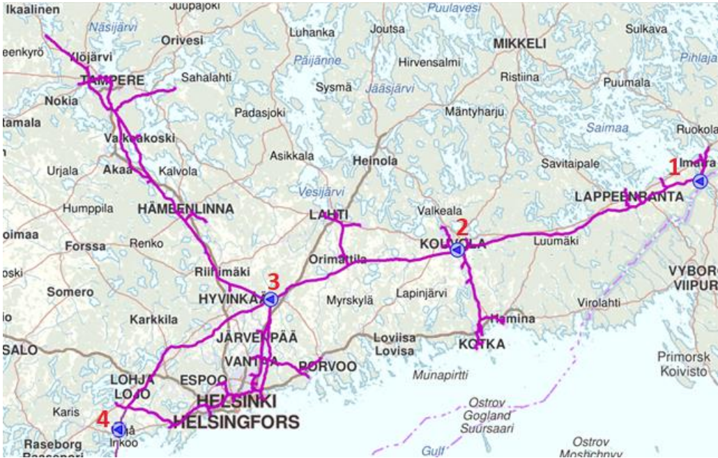
Kuva 5. Suomen kaasunsiirtojärjestelmä ja kompressoriasemat.
